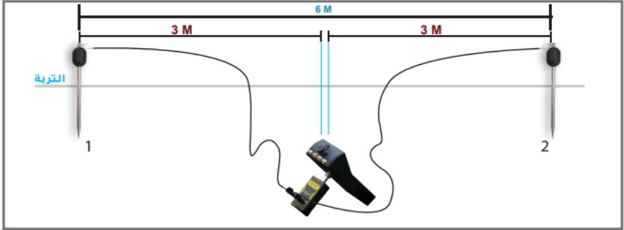
ملاحظة هامة: في حالة استمرت إشارة الخطأ لوضعية عدم اتصال الأسلاك , هذا يعني إنه هناك خطأ ما في الأسلاك ويجب التحقق منها ومن التوصيلات ما بين ملاقط التوصيل والأسلاك والمجس بشكل جيد وإذا تم التحقق وإستمرت هذه الملاحظة, هذا يعني إن ناقلية التربة ضعيفة جداً ويحتاج موضع المجسات إلى الترطيب بالماء بشكل أكثر , وفي بعض الأحيان قد تضطر إلى الحفر في موقع موضع المجس بمقدار 10 إلى 15 سم للحصول على موصلية مع التربة
